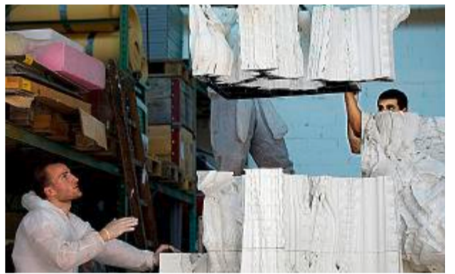
Ausgedruckter Raum «Digital Grotesque» (o.): Das Druckmaterial ist eine Mischung aus Sand und einem anorganischen Bindemittel (l.); Färben der Ausdrücke (M.); Zusammenbau
