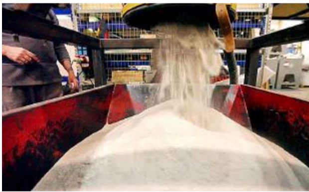
Ausgedruckter Raum «Digital Grotesque» (o.): Das Druckmaterial ist eine Mischung aus Sand und einem anorganischen Bindemittel (l.); Färben der Ausdrücke (M.); Zusammenbau
